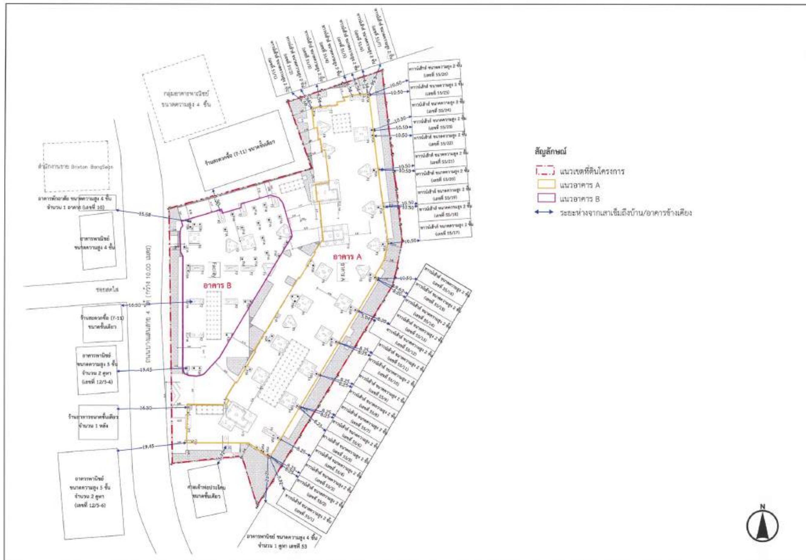
รูปที่ 4.2.1-12 แสดงระยะเสาเข็มถึงบ้าน/อาคารข้างเคียงแนวแรกทุกหลัง
